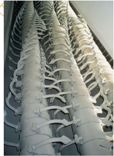
3-welliger Spezialmischer zur Flüssig- Feststoffvermischung
