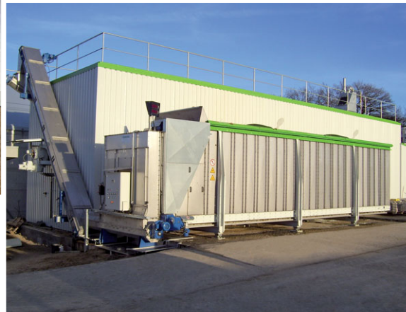
Einbringtechnik Biogas, Ausführung in Edelstahl
