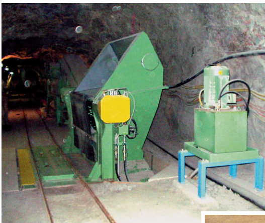
Saline Bergwerk Berchtesgaden, Loren-Kippvorrichtung mit Siebanlage, Förder- und Dosierstrecke
