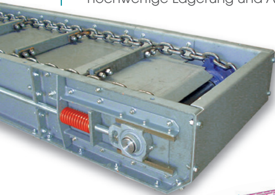
Doppelstrang-Kratzbodenförderer mit Rundgliederkette für Gesteinsbrocken, Spannstation mit Federvorspannung
