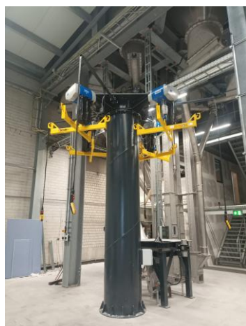
4-fach Big Bag-Verladekarussell, Big Bag-Kreuzmesser mit Entstaubung und Abförderschnecke mit Elevator
