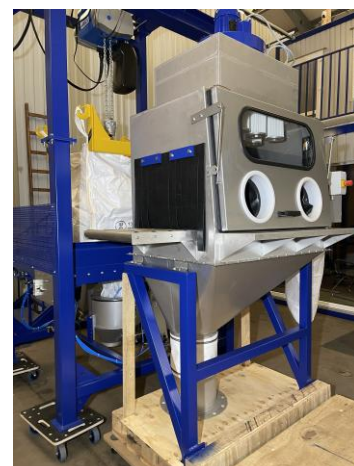
Kontaktlose Hand-Sackaufgabe-station mit Absaugung Zuführrollenbahn
