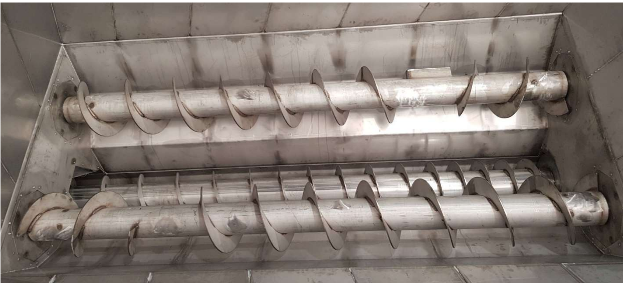
Ansicht der Speisewalze und Austragschnecke
