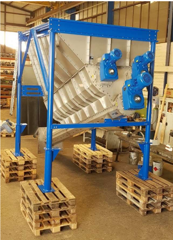
Einzelantriebe für Speisewalzen und Austragschnecke
