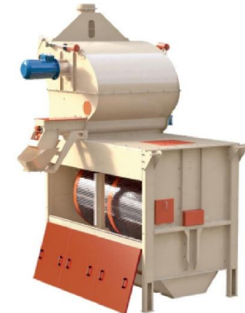
Abb. 3. Gesamtansicht von Trommelsieb SKO mit einem Aspirateur
